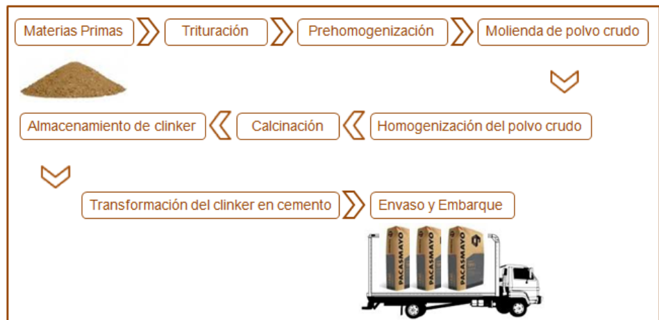
Figura 3. Proceso de producción de cemento
